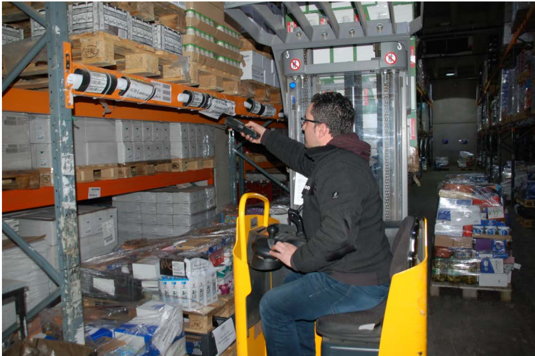
Abb. 3: Vom Stapler aus können selbst größere Distanzen überwunden und die Codes sekundenschnell gescannt werden.
