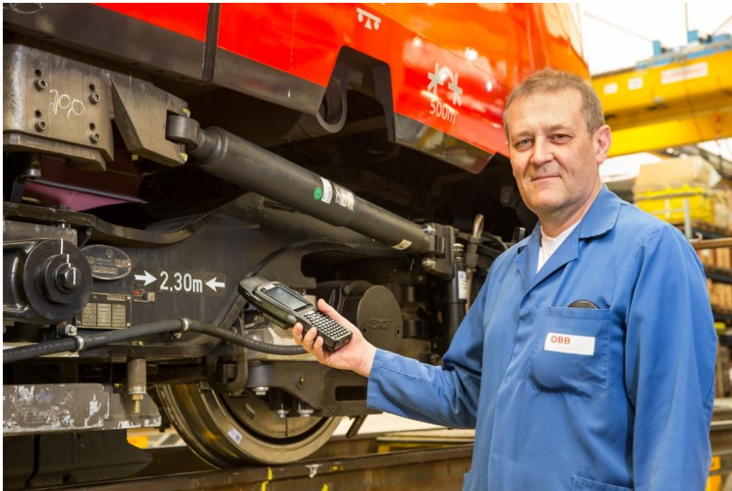
Abb. 2: Auf Knopfdruck können mit dem mobilen Datenerfassungsgerät WorkaboutPro von Barcotec Informationen über den Bauteil ausgelesen werden. Leopold Polland, Leiter Fertigungsbereich Bremstauschteile, ÖBB-Technische Services GmbH
