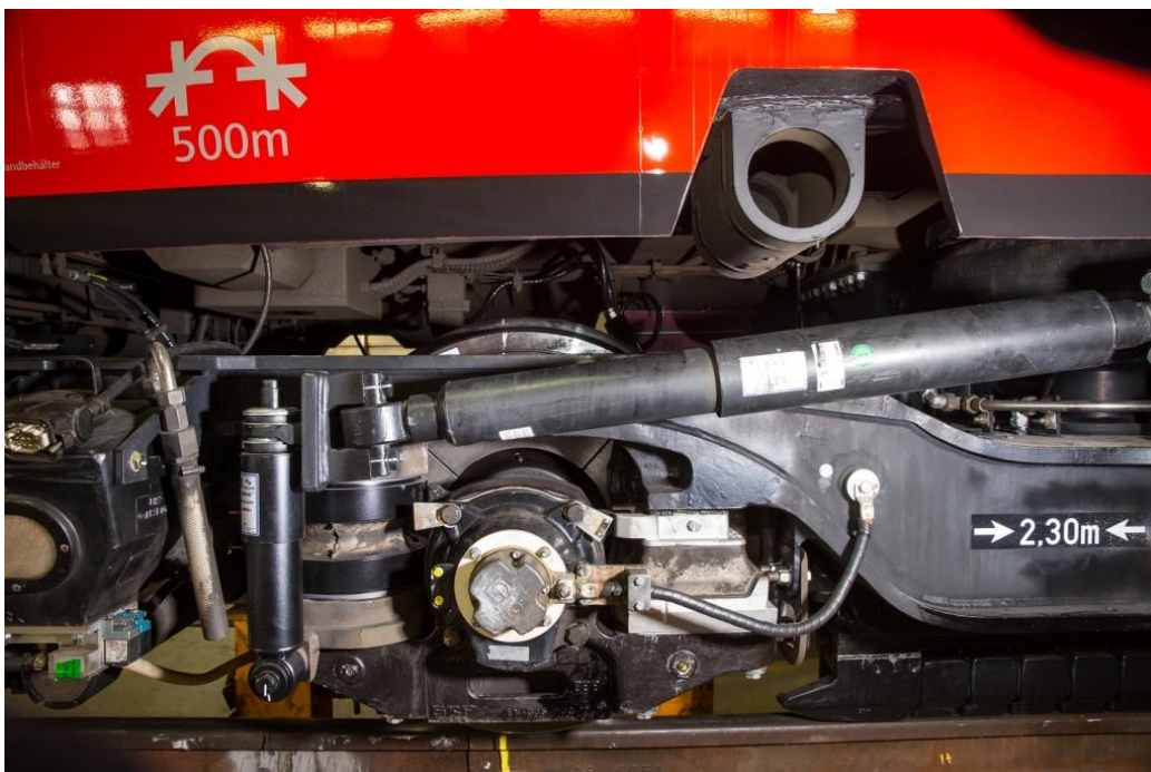
Abb. 3: Die angebrachten Tags halten extremen Temperaturen sowie Schmutz und Säure über Jahrzehnte stand.
