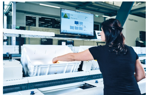
An den ergonomischen Pick-it-Easy-Arbeitsplätzen wird im Ware-zur-Person Verfahren kommissioniert (© KNAPP AG)
