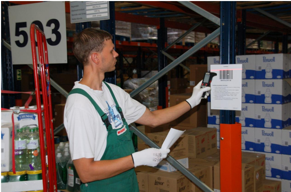
Abb. 1: Am Checkpoint werden die Daten verheiratet und auf Knopfdruck ins System samt Bilddokumentation übertragen
